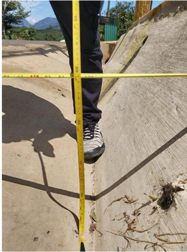
Ilustración 3 Altura del tirante hidráulico h=40\text{cm}
