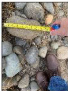
Tamaño de material mayor a la granulometría especificada
