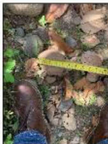
Tamaño de material mayor a la granulometría especificada
