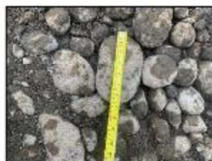
Tamaño de material mayor a la granulometría especificada
