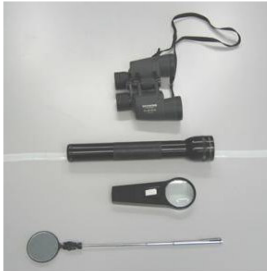
Figura 2-3 Herramientas para inspección visual
