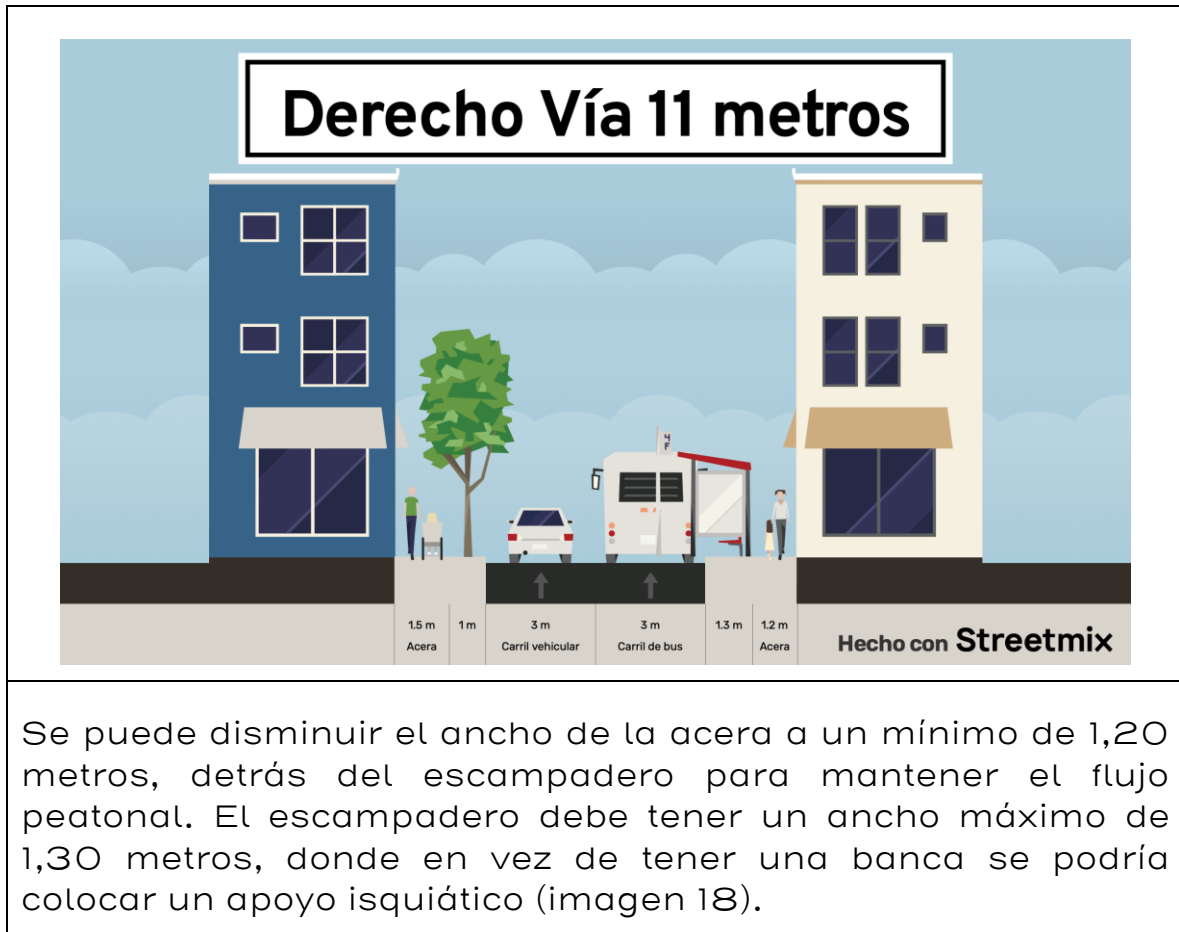
Imagen 47. Derecho de vía de 11 metros con escampadero, con paso por atrás del escampadero.
