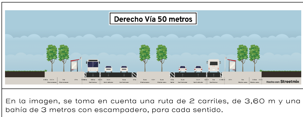
Imagen 35. Derecho de vía 50 metros, con escampadero
