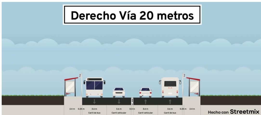
Imagen 36. Derecho de vía 20 metros, con escampadero.
