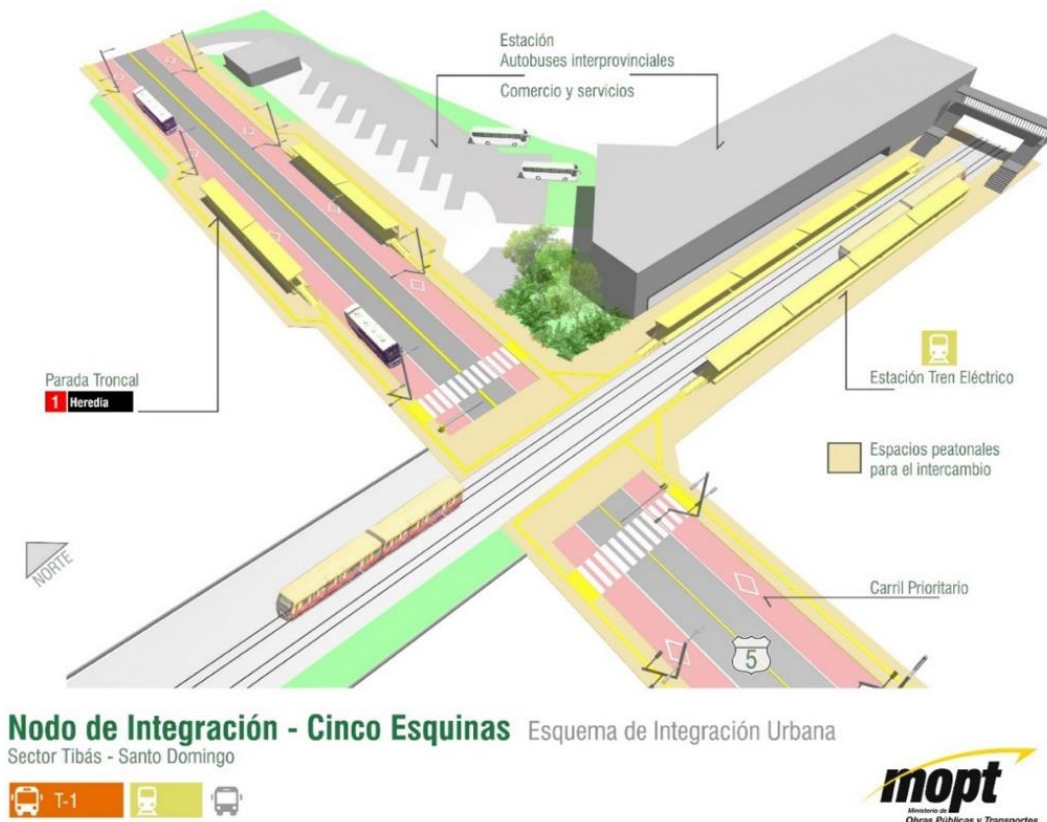
Imagen 12. Esquema gráfico de funcionamiento nodo de integración intermodal estación paradas de autobús en tránsito tren. Fuente: SPS, 2020
