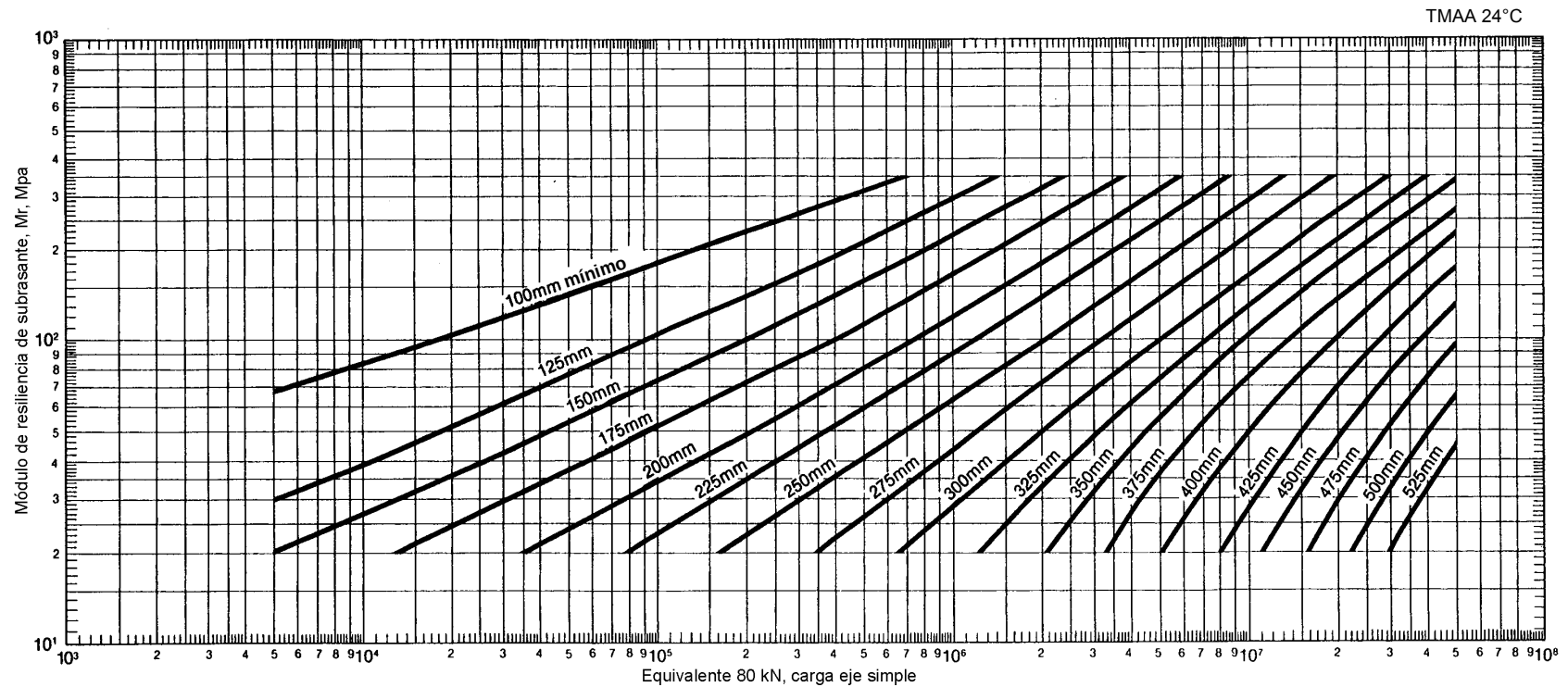
Figura 7-16 Espesor completo de concreto asfáltico
